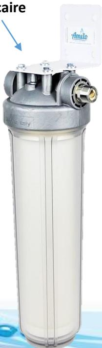
Ce système a les mêmes caractéristiques de vitalisation que le modèle habitation. La filtration s'opère à travers du charbon activé, de différentes natures selon les problématiques d'eau rencontrées. Un nettoyage automatisé, à contre courant, permet une régénération du charbon et une utilisation pour plusieurs années (minimum 5 ans).
