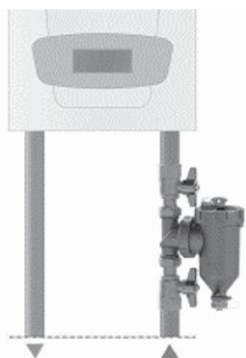
INSTALLATION SUR LA CHAUDIÈRE
