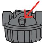
Pour faciliter l'ouverture, dévissez l'une des vis de purge des têtes de porte-filtres afin d'évacuer la pression
